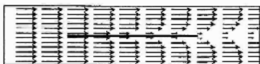
Velocidades no ar escoando em torno de uma placa fixa, paralela ao vento incidente da esquerda.
